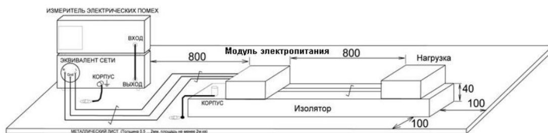
Рисунок 6.3 - Пример расположения модуля электропитания, измерительной аппаратуры и вспомогательного оборудования при измерении напряжения радиопомех в соответствии со схемой, приведенной на рисунке 6.2
