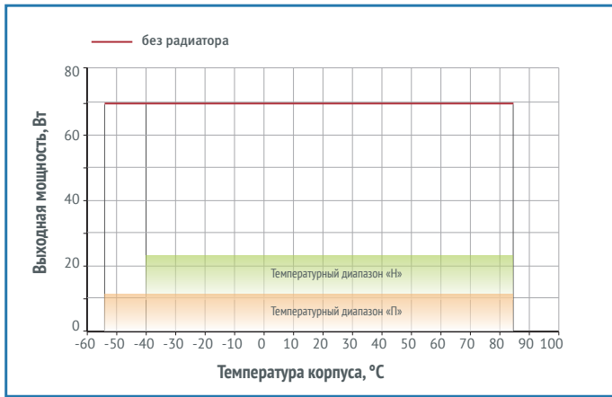
График снижения мощности в зависимости от температуры корпуса при номинальном входном напряжении ~220 В для модулей МАА60-1С24СХХ и МАА60-1С27СХХ
